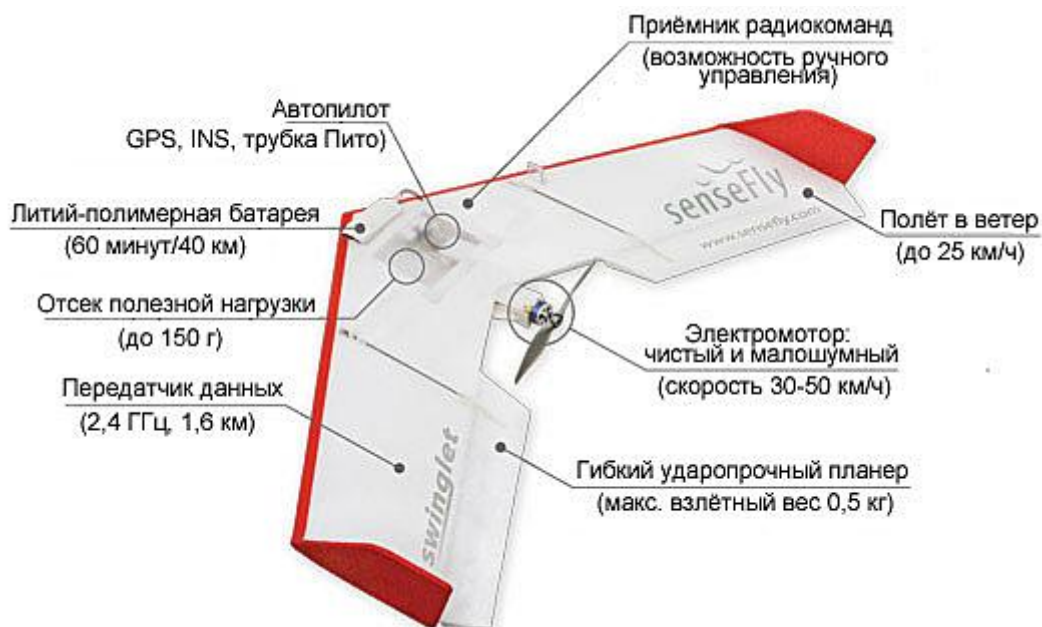
Рисунок 1.6 - Схема компоновки БПЛА Swinglet CAM
