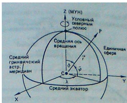
Рисунок 1.1 - Геоцентрическая система координат, связанная с Землей.
