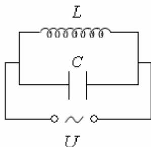
**14.261.** В цепи переменного тока (см. рисунок) с частотой  $\nu = 50$  Гц амплитуда силы тока во внешней (неразветвленной) цепи равна нулю. Определите емкость  $C$  конденсатора, если индуктивность  $L$  катушки равна  $0,2$  Гн.
