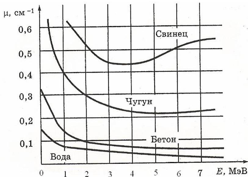
Рис. П1. Зависимость линейного коэффициента ослабления  $\mu$  от энергии  $E$   $g$ -излучения для различных веществ
