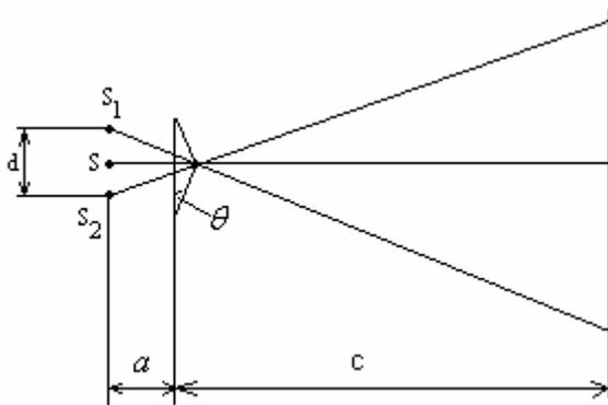
**15.380.** Расстояния от бипризмы Френеля до узкой щели и экрана соответственно равны  $a = 48$  см и  $c = 6$  м. Бипризма стеклянная ( $n = 1,5$ ) с преломляющим углом  $\theta = 10'$ . Определите число полос, наблюдаемых на экране, если длина волны  $\lambda$  монохроматического света равна 600 нм (см. рис.).
