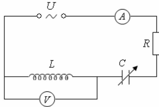
**14.255.** Определить действующие значения силы тока  $I_C$ ,  $I_{RL}$  и  $I$  на всех участках цепи, изображенной на рисунке, если  $R = 1 \text{ Ом}$ ,  $L = 1,00 \text{ мГн}$ ,  $C = 0,111 \text{ мкФ}$ ,  $U = 30 \text{ В}$ ,  $\omega = 1,00 \cdot 10^5 \frac{\text{рад}}{\text{с}}$ .
