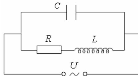
**14.256.** Колебательный контур состоит из конденсатора емкостью  $C = 5,0 \text{ мкФ}$  и катушки индуктивности  $L = 0,2 \text{ Гн}$ . Определить максимальную силу тока  $I_m$  в контуре, если максимальная разность потенциалов на обкладках конденсатора  $U_m = 90 \text{ В}$ . Сопротивлением контура  $R$  пренебречь.
