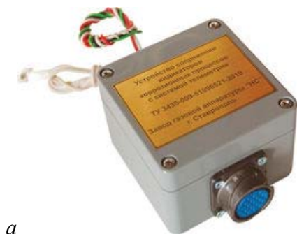
Рис. 2. Элементы индикатора коррозионных процессов: а – устройство сопряжения ИКП с системой телеметрии; б – анализатор индикаторов коррозионных процессов
