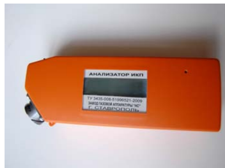
Рис. 2. Элементы индикатора коррозионных процессов: а – устройство сопряжения ИКП с системой телеметрии; б – анализатор индикаторов коррозионных процессов
