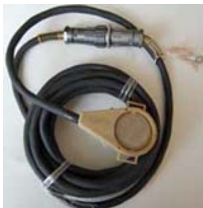
Рис. 1. Индикатор коррозионных процессов ИКП
