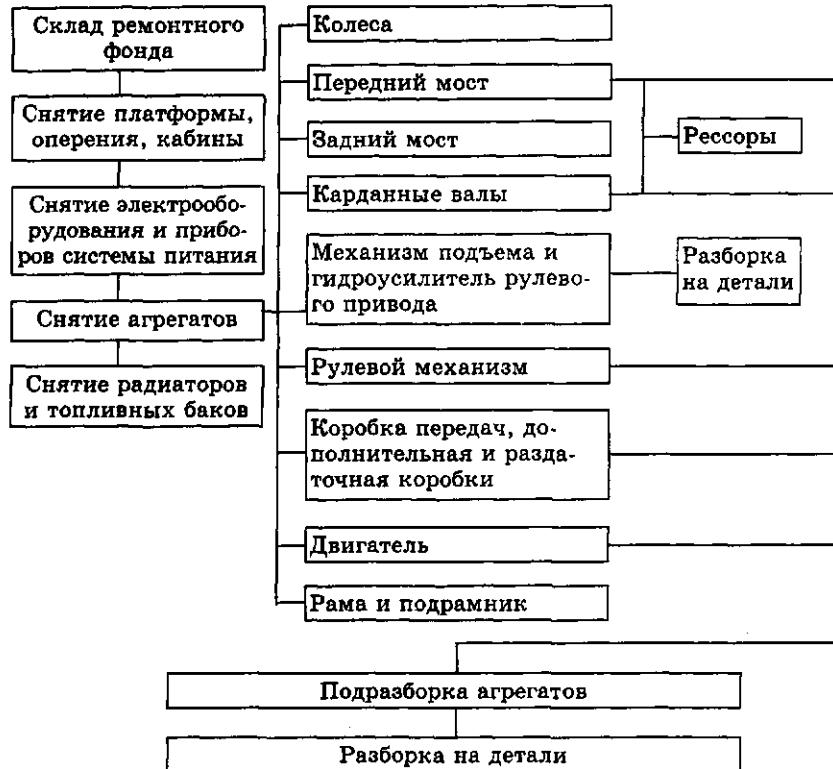
Рис.2.1. Схема разборки автомобиля
