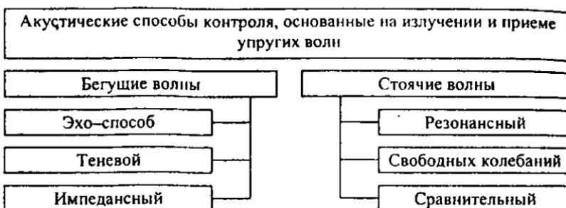
Рис. 2. 15. Классификация акустических способов контроля.
