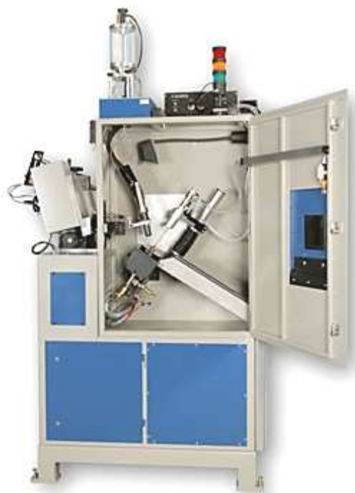
Рис. 2.27. Фотография установки Valve Star II для наплавки фасок клапанов автомобильных двигателей
