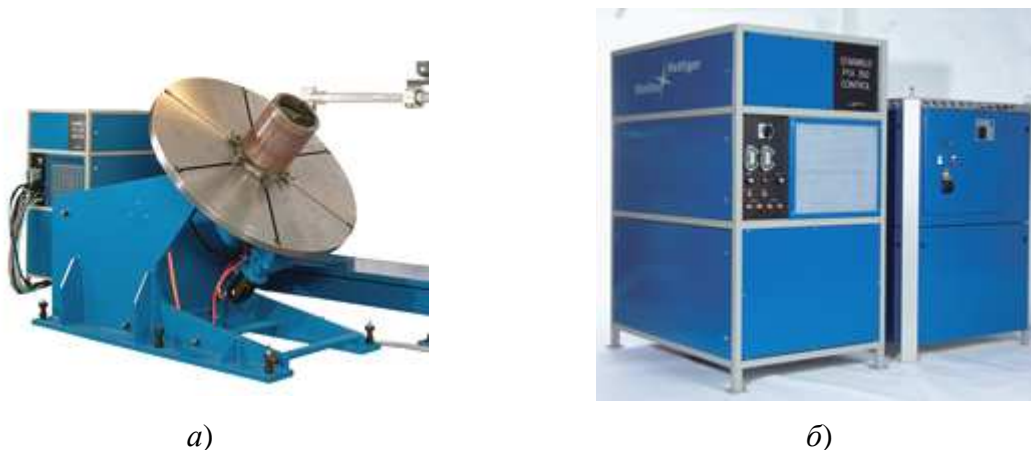
Рис. 2.26. Фотографии элементов установок для наплавки: а – позиционер для установки и вращения деталей; б – источник питания и система охлаждения (справа); в – порошковый питатель для наплавки под флюсом; г – блок управления установкой (см. также с. 59)
