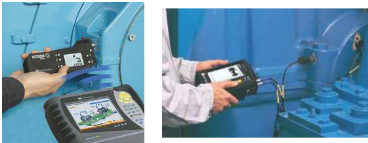
Рис. 2.87. Примеры проведения виброакустической диагностики агрегатов (датчики приборов установлены на корпусе агрегатов)
