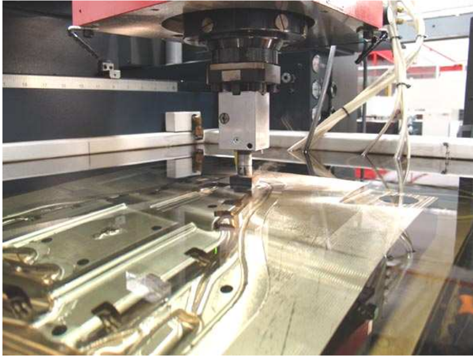
Рис. 2.59. Фотография электроэрозионного станка в процессе обработки заготовки (обрабатываемая заготовка погружена в жидкость)
