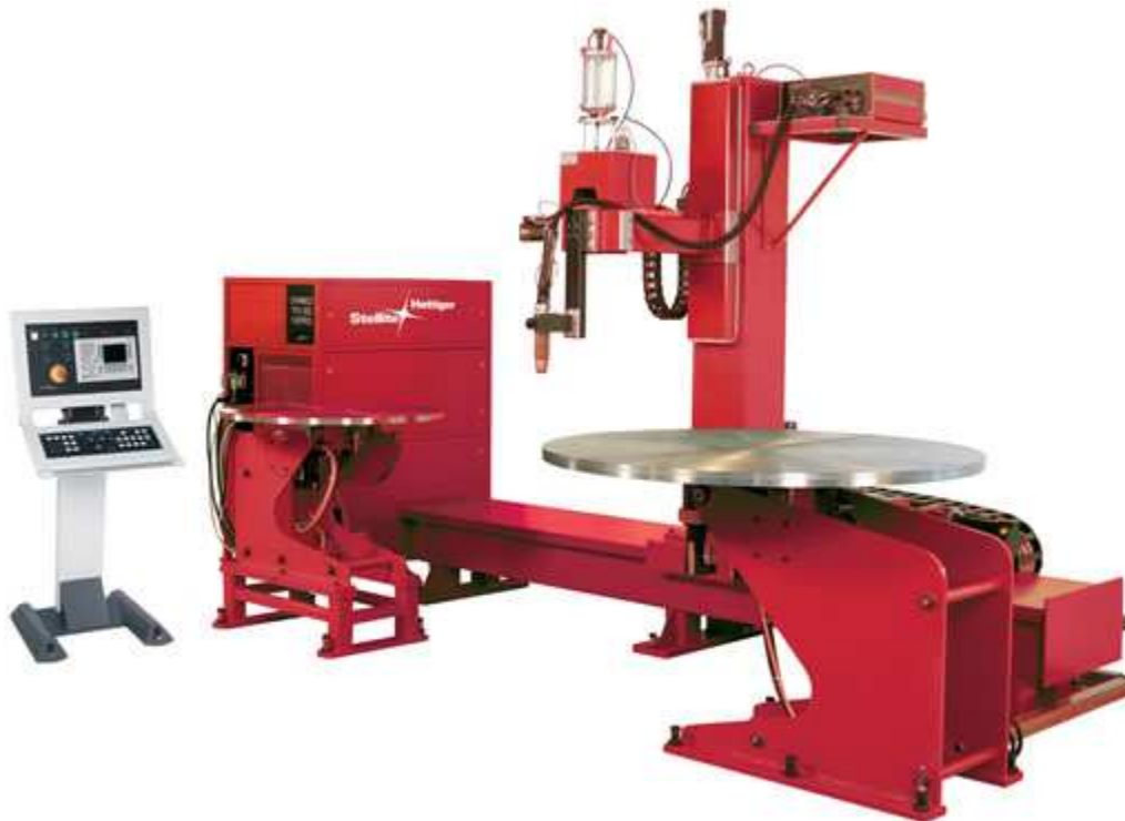
Рис. 2.30. Фотография установки Coating Star III с двумя стойками для плазменной наплавки
