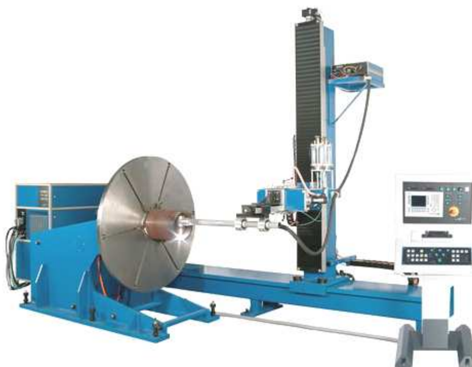
Рис. 2.29. Фотография модернизированной установки Coating Star III с поворотным столом для плазменной наплавки
