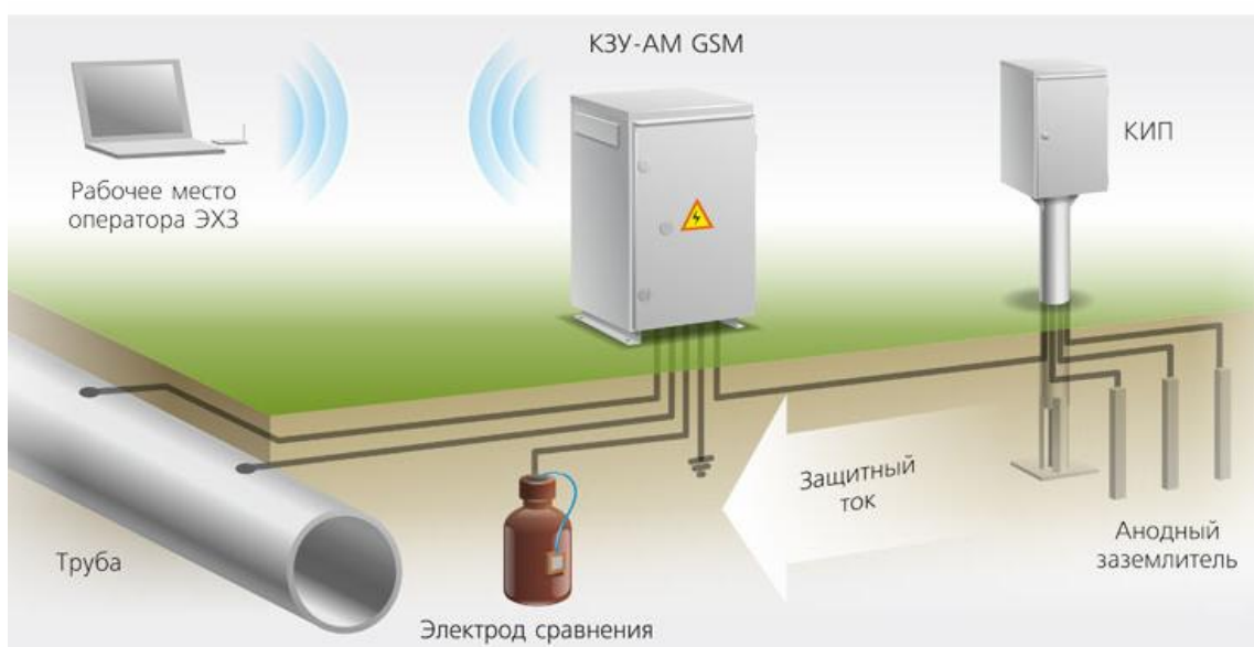
Рисунок 5.1 – Устройство электрохимзащиты стального газопровода
