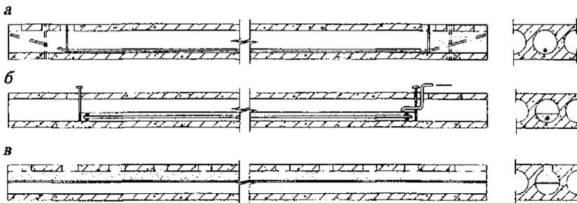
Рис. 1.20. Методы усиления сборных железобетонных многопустотных панелей перекрытия без предварительного напряжения дополнительной арматуры:
