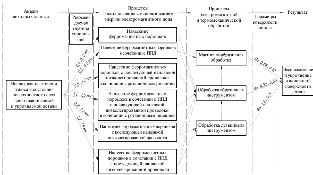
Рис. 1. Схема технологии восстановления предельно изношенных поверхностей деталей машин
