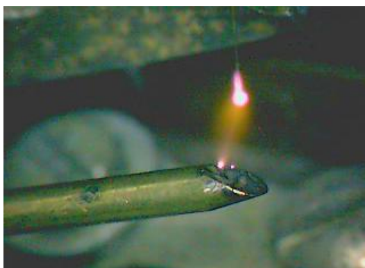
Рис. 2. Форма искрового разряда на кончике медной проволоки диаметром 50 мкм при положительной полярности на электроде
