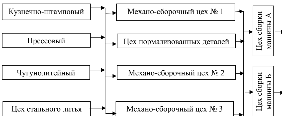
Рис. 3.8. Схема движения деталей по цехам образованным по смешанному принципу
