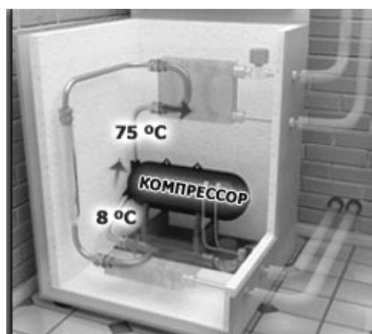
Рис. 2.6. Схема сжатия фреона
