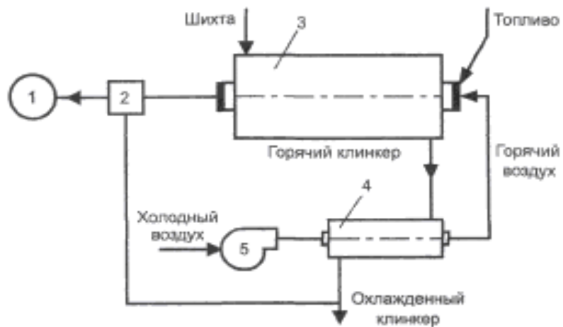
Рис. 6.9. Схема установки для утилизации теплоты при производстве клинкера
