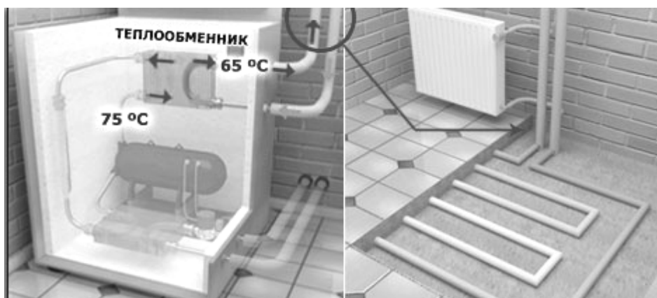
Рис. 2.7. Схема передачи тепла фреона в третий контур
