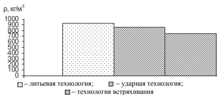
Рис. 3. Сравнительные данные плотности ячеистого бетона
