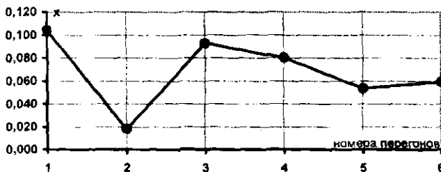
Рис. 5. Изменение степени ламинаризации в зависимости от расстояния до точки впрыска
