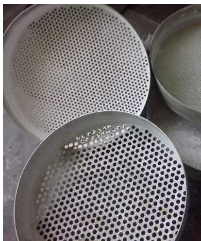
Рис. 8. Сита для отсева гранул на фракции
