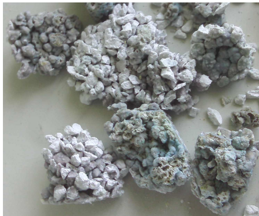
Рис. 2. Конгломераты спекшихся гранул кислородсодержащего продукта
