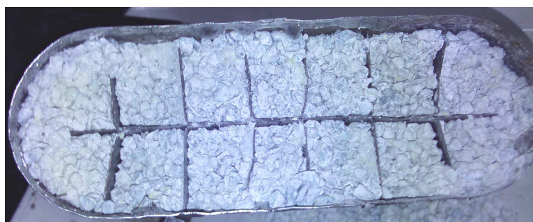
Рис. 5. Расположение элемента теплораспределителя в патроне
