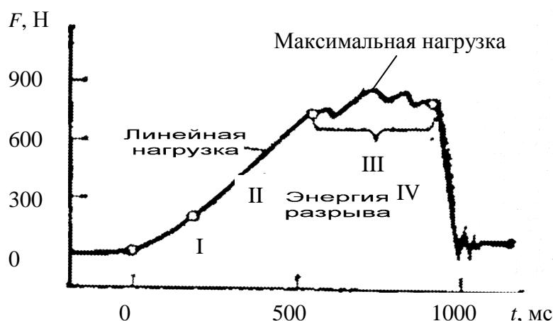
Рис. 12. Зависимость сила-время при растягивании препарата (передняя крестообразная связка) со скоростью 0,66 % длины в секунду (по Butler et. al., 1978)
