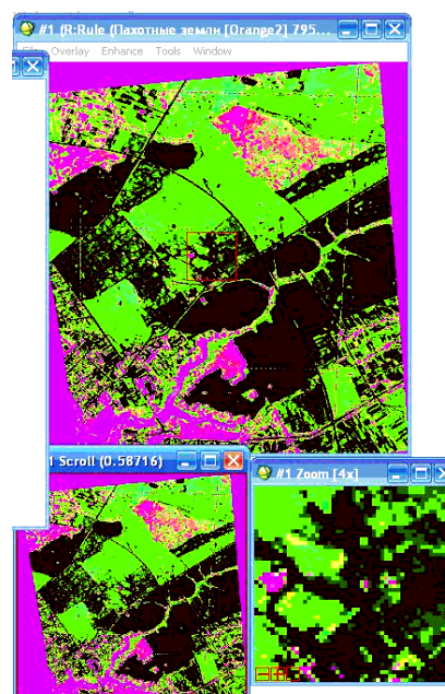
Рис. 4. Отдешифрованное изображение методом параллелепипеда в цвете RGB
