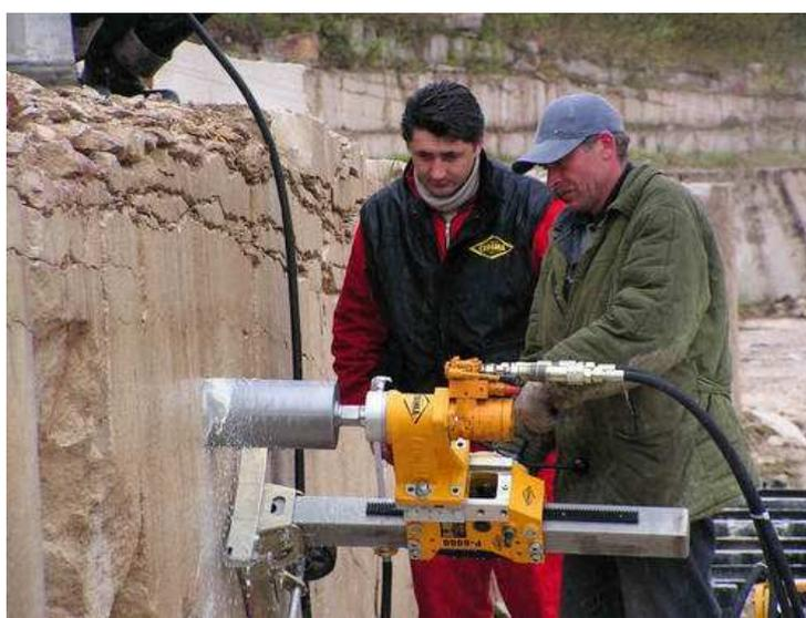
Рис. 2.17. Сверление бетона с использованием технологии алмазной резки
