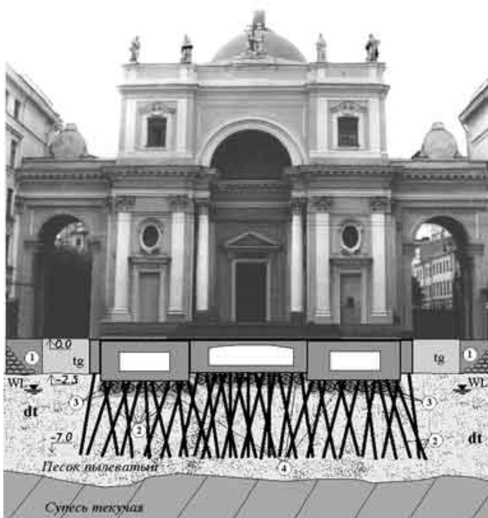
Рис. 3.14. Усиление оснований и фундаментов костела Св. Екатерины в Санкт-Петербурге: 1 – бутовые фундаменты; 2 – буроинъекционные сваи; 3 – деревянные бревна-лежни; 4 – бетонный слой на контакте фундамент – грунт
