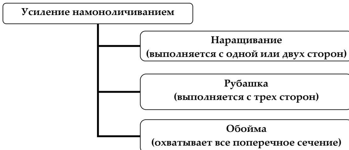
Рис. 5.1. Условная классификация способов усиления намоноличиванием
