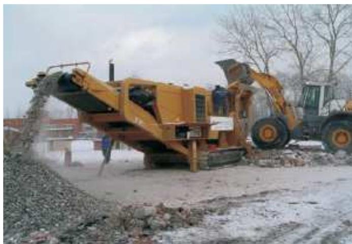
Рис. 2.13. Работа мобильного дробильного комплекса при переработке строительных отходов
