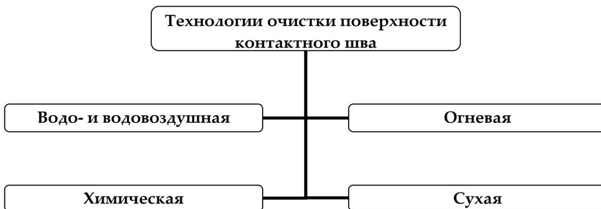
Рис. 5.5. Условная классификация технологий очистки поверхности
