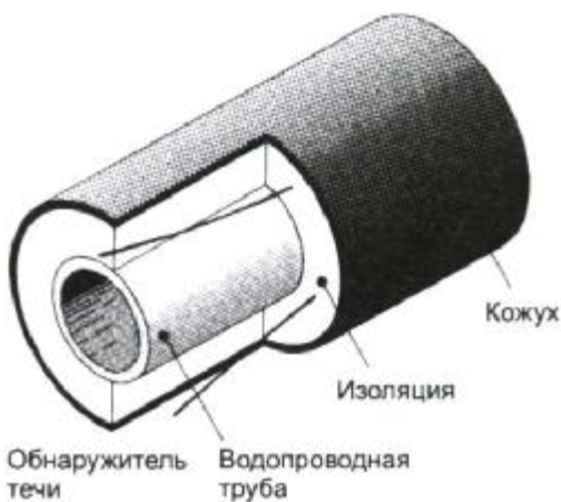
Рис. 4.2. Схема элемента предварительно изолированного теплопровода
