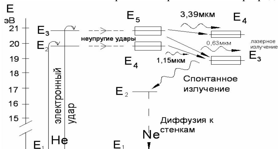
Рис. 6.4 Схема распределения разрешенных энергетических состояний атомов гелия и неона
