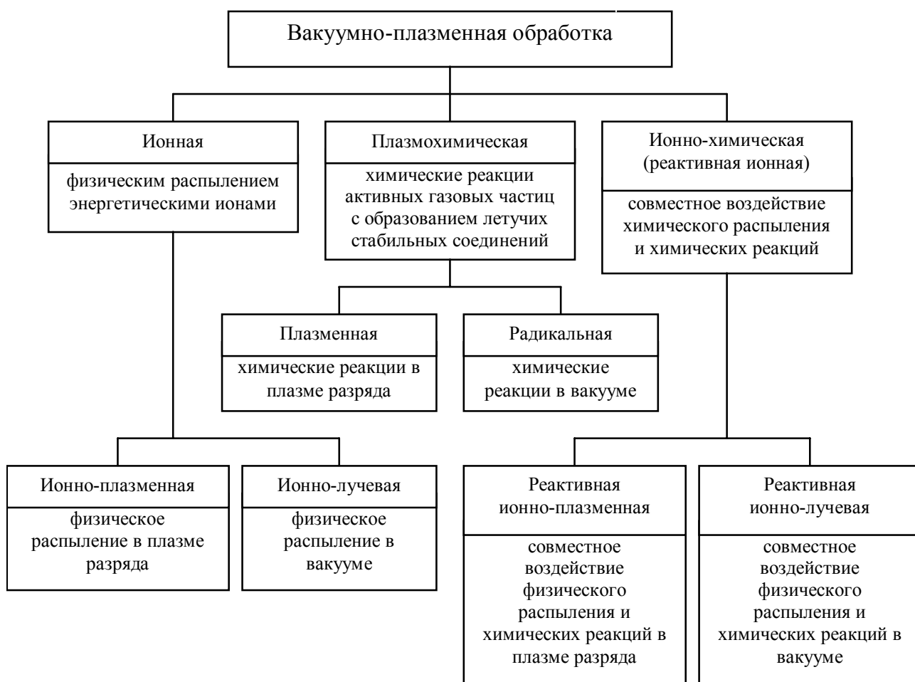
Рис. 2.7 Классификация плазменных технологических процессов по механизму воздействия на обрабатываемую поверхность
