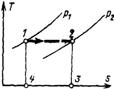
в изотермическом процессе площадь 1-2-3-4-1, лежащая под линией процесса, представляет собой внешнюю теплоту, за счет которой и совершается работа расширения газа;
