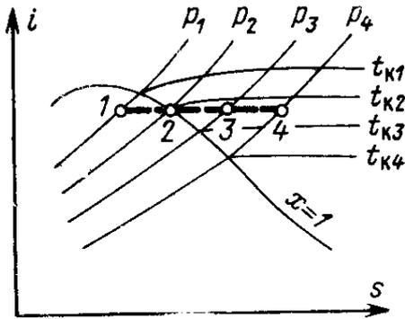
Из графика видно, что влажный пар в области умеренных давлений (точка 1) при дросселировании подсушивается, сухой насыщенный пар (точка 2) перегревается, а перегретый (точка 3) увеличивает свой перегрев.
