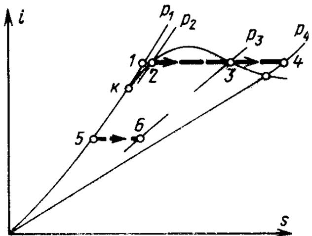
В области высоких давлений, близких к критическому, перегретый пар (точка 1) сначала переходит в сухой насыщенный (точка 2), затем увлажняется, затем снова подсушивается, становясь сухим насыщенным (точка 3), и, наконец, вновь становится перегретым (точка 4)
