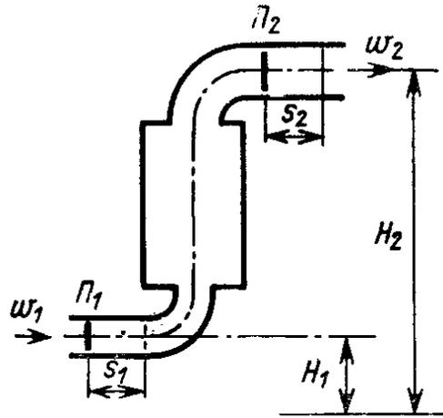
Предположим, что поток рабочего тела поступает в какой-либо теплотехнический аппарат через входной канал с параметрами  $p_1, J_1, T_1$  и скоростью  $w_1$  на геометрической высоте  $H_1$  от условного уровня отсчета.
