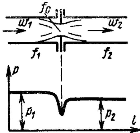
Если на пути движения потока газа или пара имеется местное сопротивление, т. е. резкое сужение проходного сечения (например, диафрагма с небольшим отверстием в центре), то в месте сужения скорость резко возрастает, а давление понижается. При последующем понижении скорости из-за завихрений давление восстанавливается не полностью, как показано на графике. Перепад давления  $\Delta p = p_1 - p_2$
