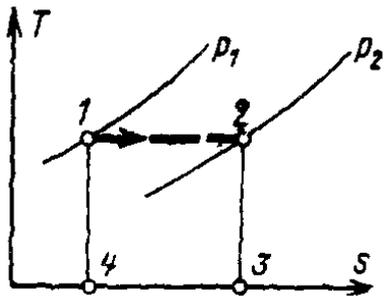
Горизонтальную прямую 1-2 можно рассматривать как линию процесса дросселирования лишь условно, поскольку в принципе графическому изображению поддаются лишь обратимые процессы и фактически линия 1-2 изображает не дросселирование, а обратимое изотермическое расширение газа.
