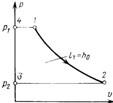
Это равенство показывает, что в данном случае площадь 1-2-3-4-1, заключенная между линией процесса в аппарате 1-2 и осью ординат, изображает собой только техническую работу потока.
