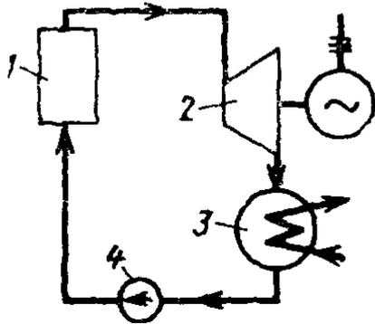
В результате замены парового компрессора насосом, подающим в котел конденсат отработавшего пара, а также введения перегрева пара перед двигателем цикл Карно превращается уже в другой цикл, называемый *циклом Ренкина*.
