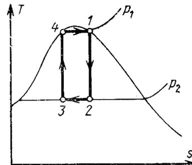
При использовании сухого насыщенного пара с параметрами  $p_1=170$  бар и  $t_1=352^\circ\text{C}$  (верхний температурный уровень цикла) конечная влажность его при адиабатном расширении до  $p_2=0,03$  бар по расчёту составляет 41,3%.
