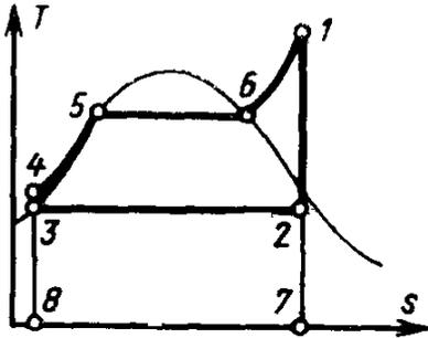
площадь 4-5-6-1-7-8-4 – тепло  $q_1$ , получаемое рабочим телом от горячего источника (газообразных продуктов сгорания топлива),
