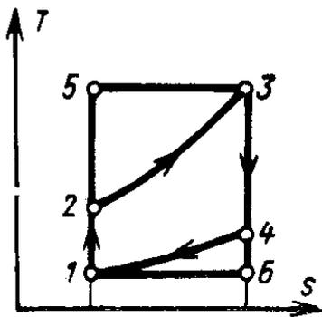
У газовых циклов коэффициент заполнения значительно меньше единицы, потому что изобарные процессы подвода тепла (линия 2-3) и отвода тепла (линия 4-1) осуществляются при переменной температуре.
