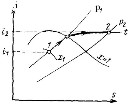
В  $i$ - $s$ -диаграмме график этого процесса изображается ломаной линией 1-2, которая в области влажного пара имеет вид наклонной прямой, а в области перегретого пара – кривой, обращенной выпуклостью вверх и приближающейся к горизонтальной прямой. Начальная точка находится на пересечении
