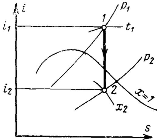
В  $i$ - $s$ -диаграмме график этого процесса имеет вид вертикальной прямой 1-2. Начальная точка этого процесса 1 находится на пересечении изобары  $p_1$  с изотермой  $t_1$ , а конечная точка 2 – на пересечении изобары  $p_2$  с линией постоянной степени сухости  $x_2$ .
