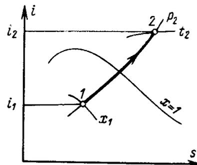
конечная точка 2 – на пересечении той же изобары с изотермой  $t_2$ .
