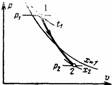
При адиабатном расширении перегретого пара он становится сначала сухим насыщенным, а затем влажным, причем с понижением давления степень сухости его уменьшается.
