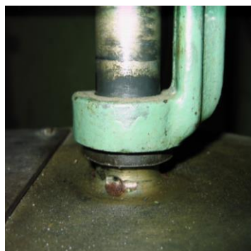
Рис. 3. Упор-ограничитель при динамическом воздействии: а – площадка в момент сжатия пружин; б – площадка в момент удара
