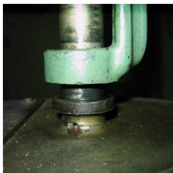
Рис. 3. Упор-ограничитель при динамическом воздействии: а – площадка в момент сжатия пружин; б – площадка в момент удара
