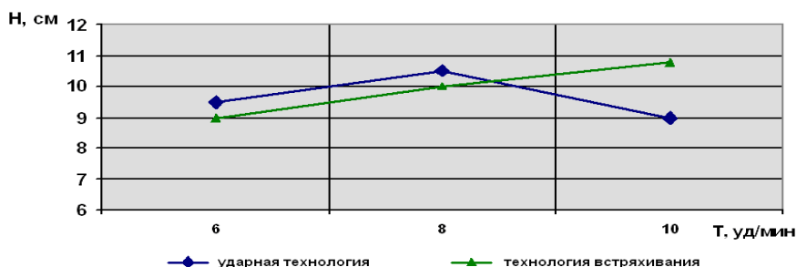
Рис. 6. Влияние частоты ударов на эффективность вспучивания при амплитуде ударов 1 см
