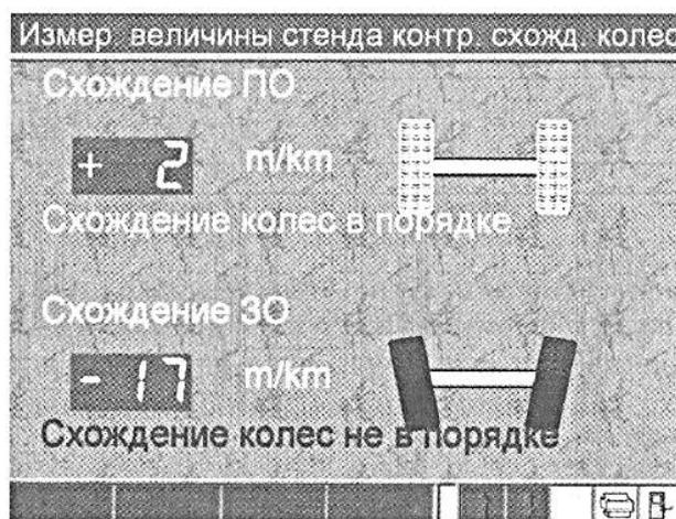
Рисунок 3.6. Данные контроля схождения колес автомобиля.
