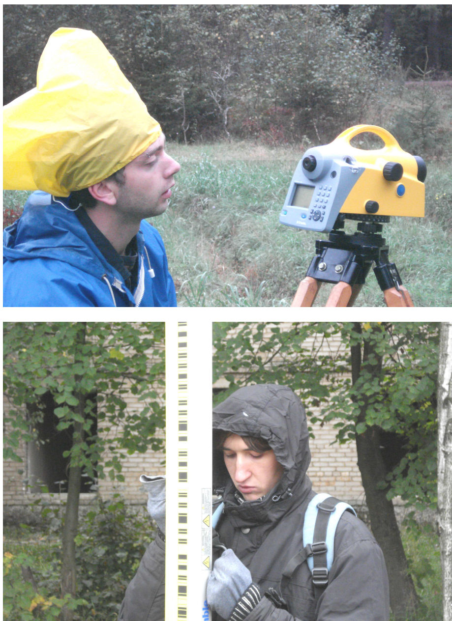
Рис. 1.1. Комплект высокоточного электронного нивелира DiNi03 со штриховыми рейками при работе на Полоцком геодинамическом профиле
