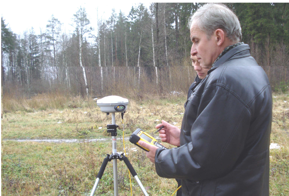
Рис. 1.2. Выполнение спутниковых измерений GPS приемниками фирмы TRIMBLE на Полоцком профиле ст. преподавателем С.К. Товбасом
