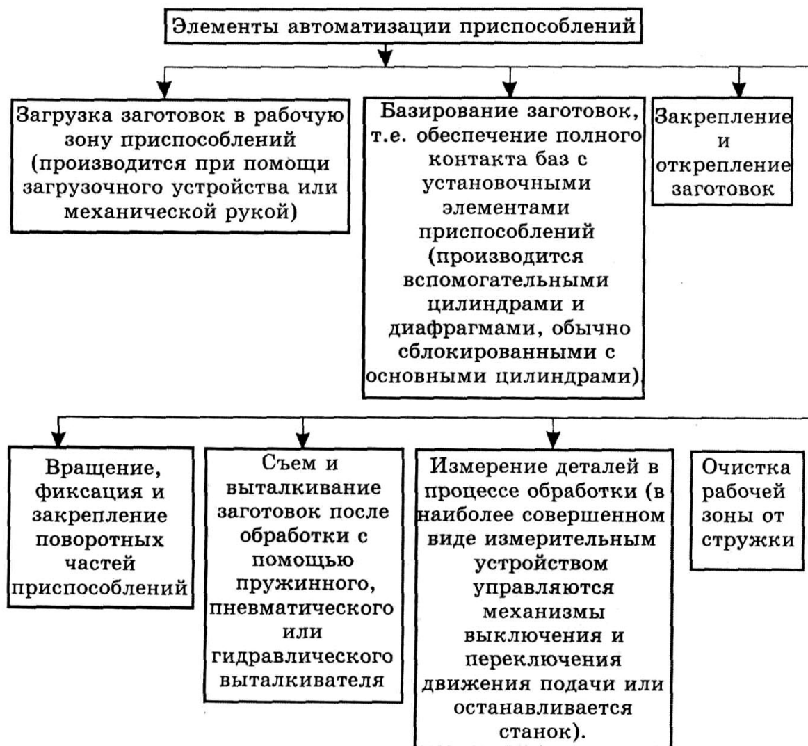
Рис. 14.2. Схема автоматизации элементов приспособлений
