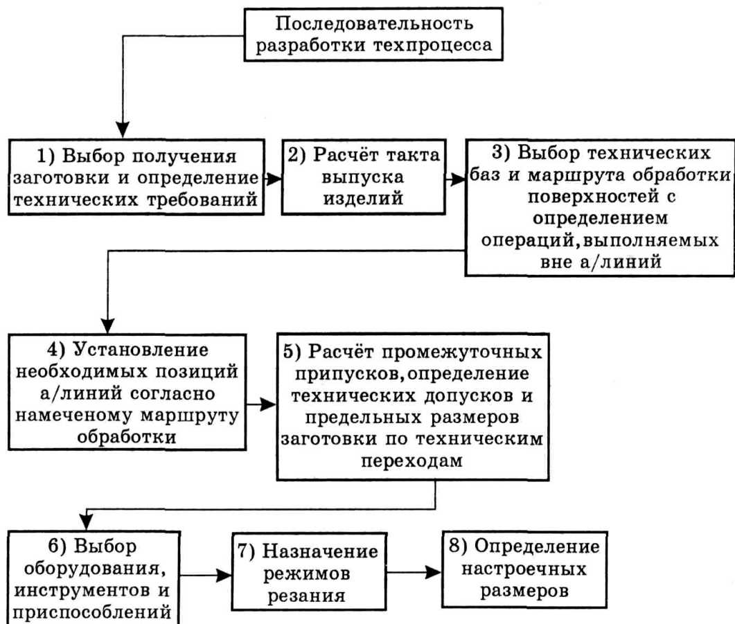
Рис. 14.12. Последовательность разработки техпроцесса механической обработки с использованием автоматической линии
