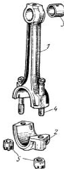
Рис. 6.143. Внешний вид шатуна: 1 – тело; 2 – крышка; 3 – втулка; 4 – болты; 5 – гайка
