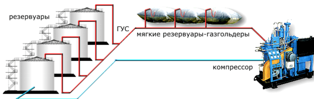
Рис. 5. Схема газовой обвязки нефтебазы с компрессорной установкой ГТ 0, 8-0,25/41С ОАО «Мелком»
