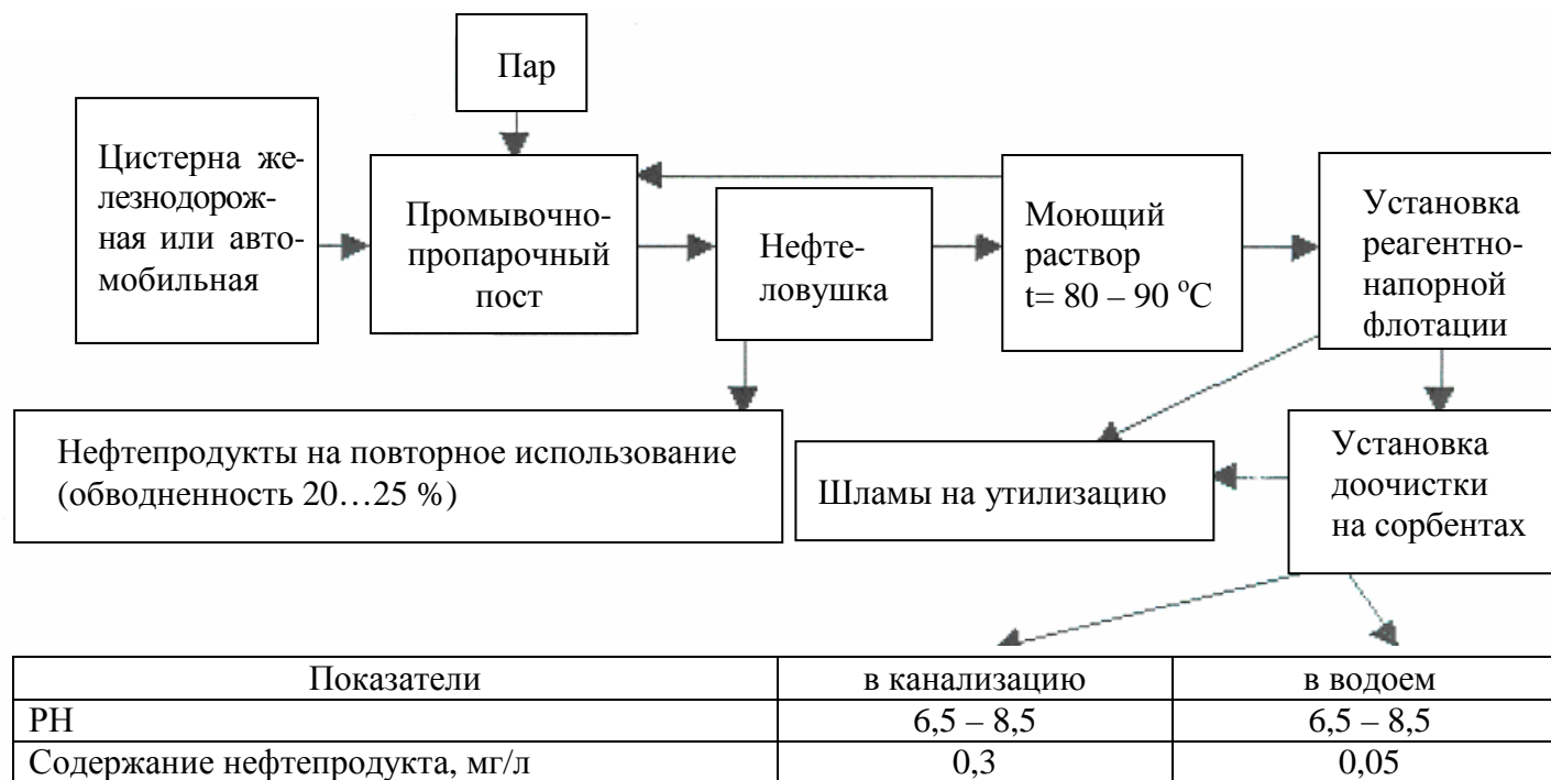
Схема отмывки железнодорожных и автомобильных цистерн с применением моющих средств семейства «О-БИС»
