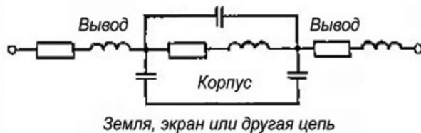
Рис. 7.19. Эквивалентная схема индуктивной катушки
