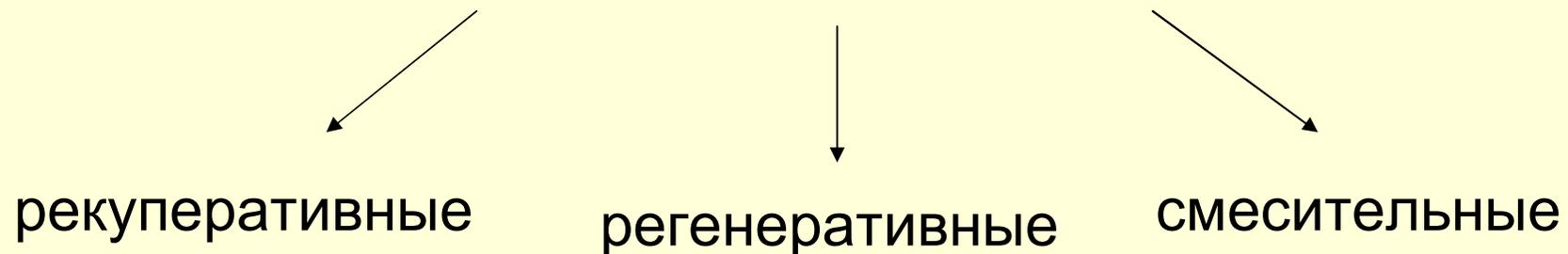
*Рекуперативные* - аппараты, в которых теплота от горячего теплоносителя к холодному передается через разделяющую их стенку (парогенераторы, подогреватели, конденсаторы и т. п.)
