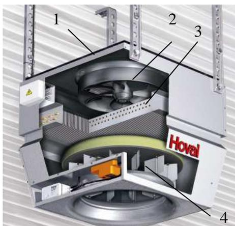
Рис. 3.15. Подвесной воздушно-рециркуляционный отопительный агрегат: 1 – корпус; 2 – вентиляторный агрегат; 3 – калорифер; 4 – воздухо-распределитель вихревого типа
