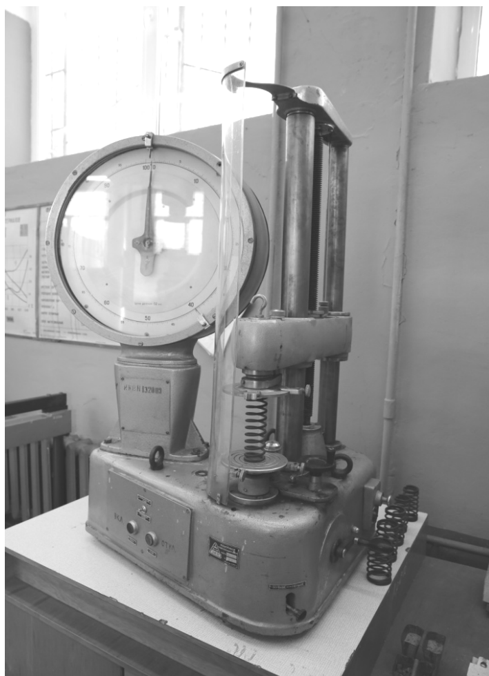
Рис. 4. Общий вид машины для статических испытаний пружин МИП-100-2
