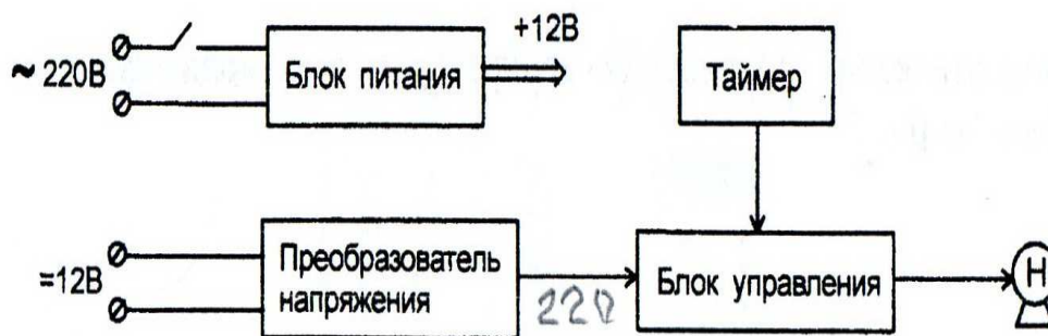
Рис. 12.4. Блок-схема электрических соединений aspirатора ОП
