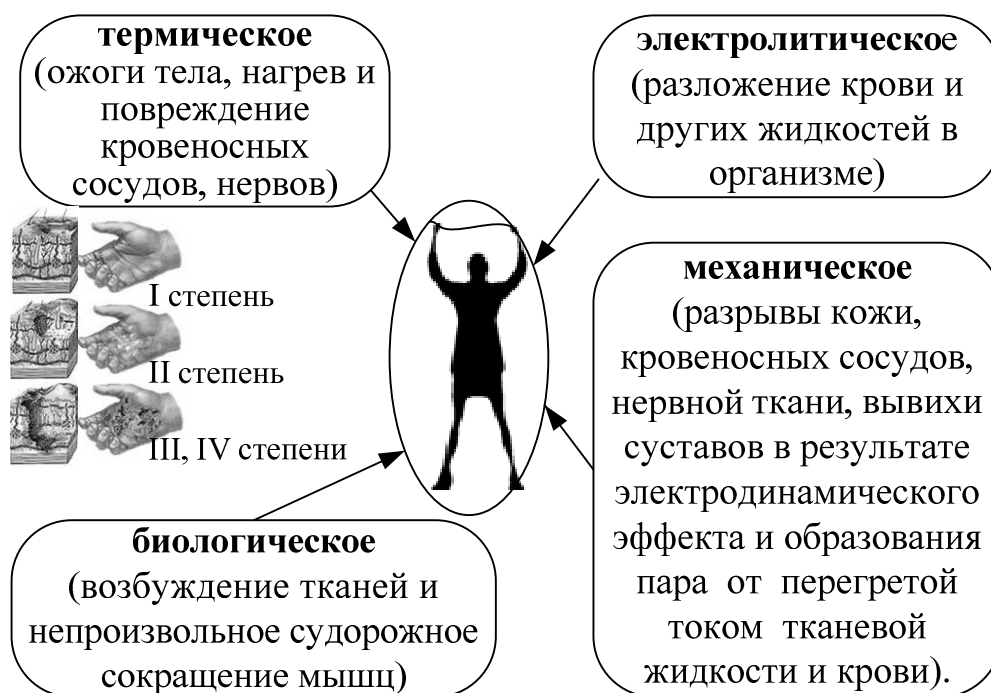
Рис. 13. Виды воздействия электрического тока на человека
