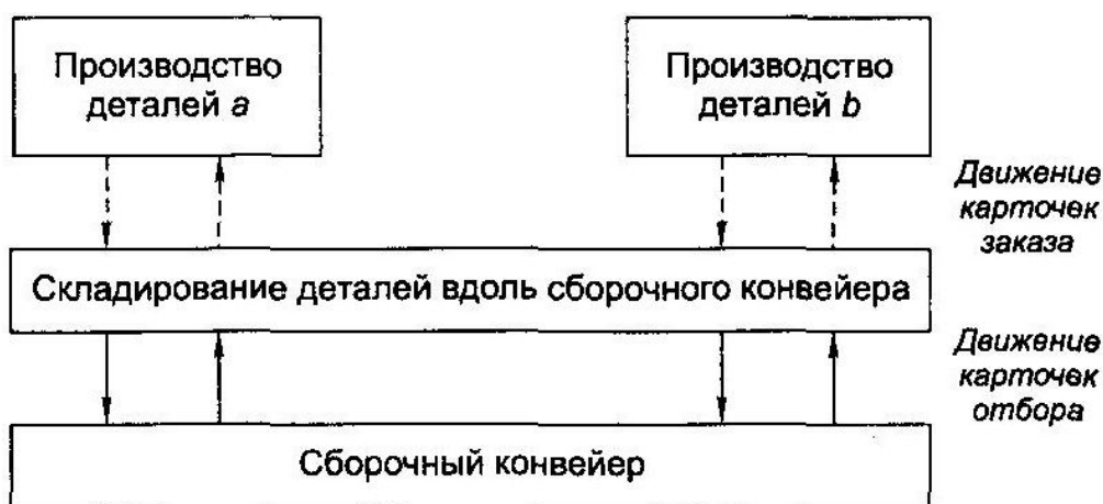
Рис. 11.5. Схема обращения карточек в системе КАНБАН [16]
