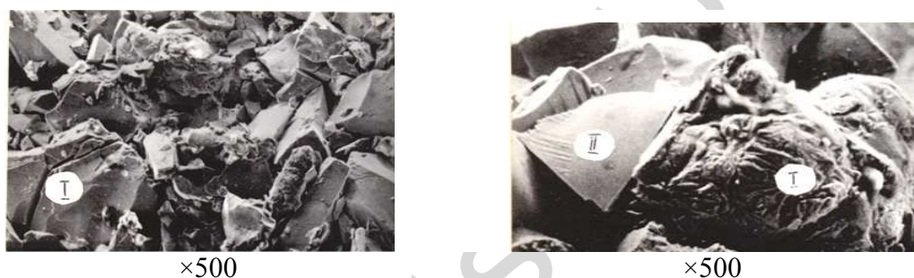
Рис. 2. Фрактограмма покрытия, полученного ЭКП шихты из 60%ПГ-С1 и 40%ФХ-800 (1-участок разрушения частиц ФХ-800)
