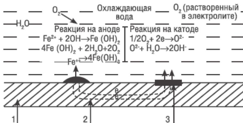
Рис.4.3. Механизм электрохимической коррозии в системе «металл – воздух – вода»:
