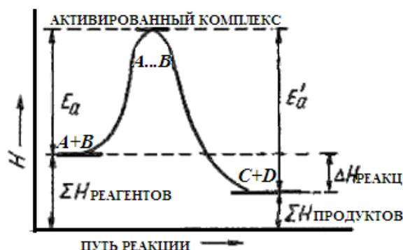
Рис. 2.1. Энергетическая схема хода реакции  $A + B = C + D$
