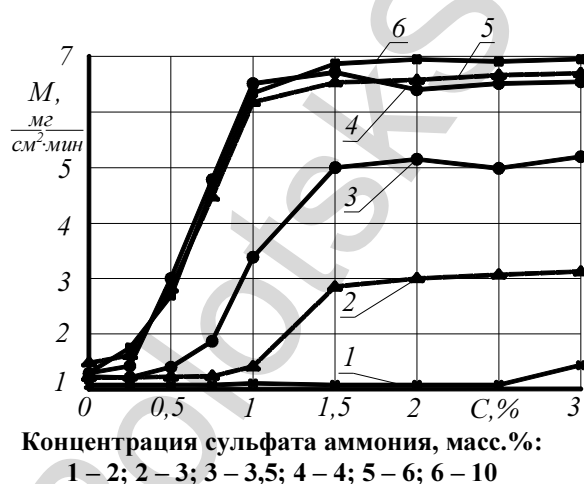
Рис. 1. Зависимость удельного съема металла от концентрации лимонной кислоты в водном растворе сульфата аммония (сталь 20X13; U=310 В; T_{эл}=70 °С)
