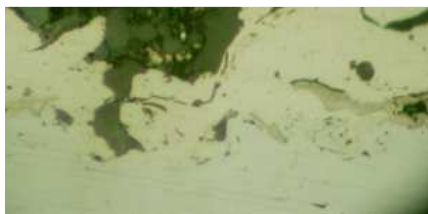
Рис. 5. Микроструктура границы раздела боридных покрытий со стальной основой
