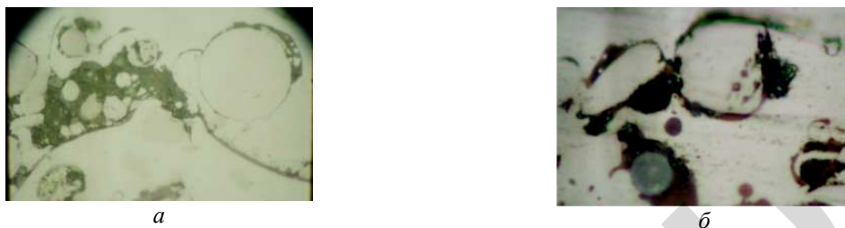
Рис. 4. Микроструктура покрытий, содержащих дибориды: a – хрома, б – титана
