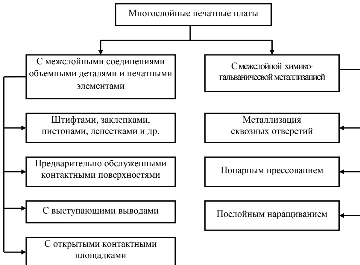
Рис. 3.2. Классификация многослойных печатных плат
