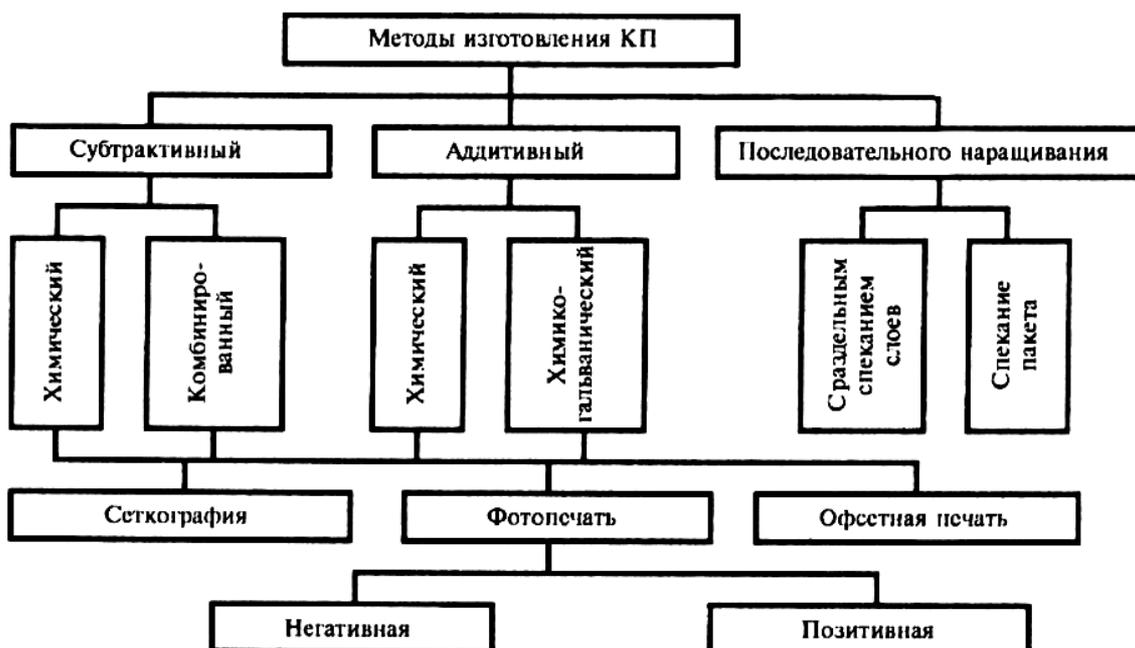
Рис. 3.11. Методы изготовления коммутационных плат и нанесения рисунка
