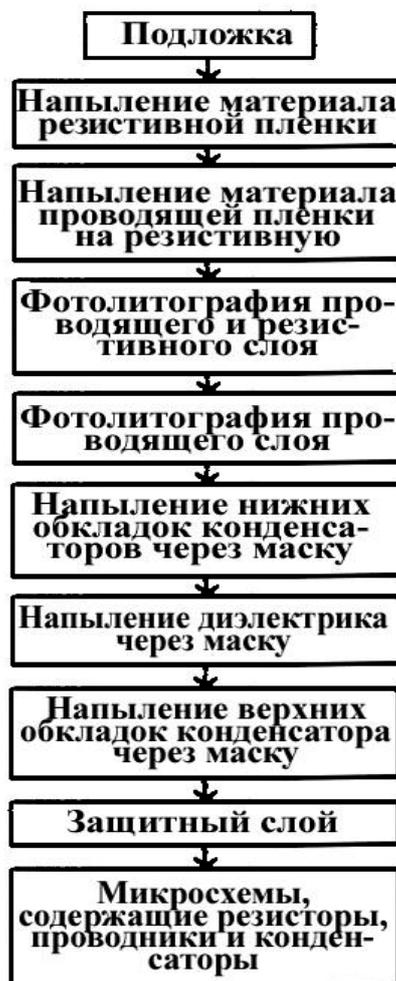
Рис. 3.30. Схема технологического процесса изготовления тонкопленочных ГИМС
