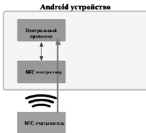
Рис. 1. Схема работы Host Card Emulation
