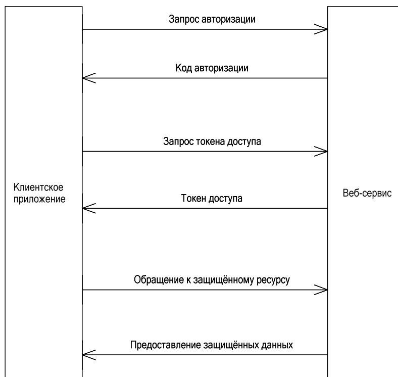
Рис. 1. Схема потока аутентификации OAuth 2
