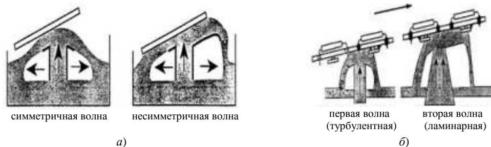
Рис. 5. Волновое нанесение клея
