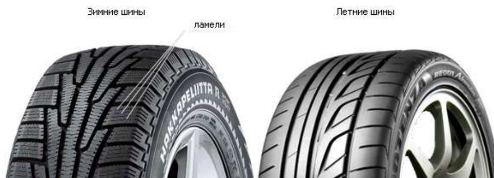
Рис. 1. Внешние отличия протектора зимних и летних шин
