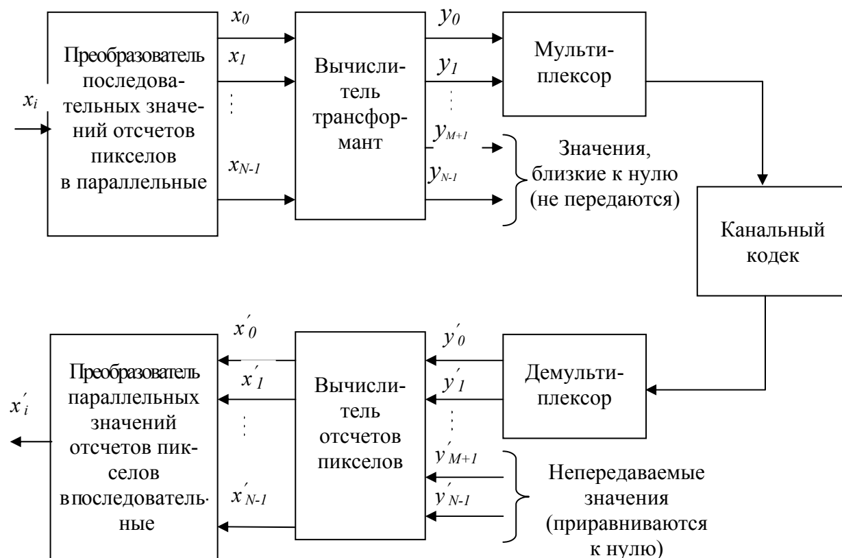
Рис. 3.5. Структурная схема кодирования изображения на основе дискретного ортогонального преобразования
