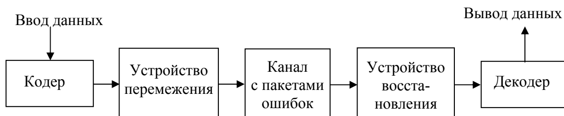
Рис. 6.23. Структурная схема применения внешних устройств перемежения и восстановления после перемежения
