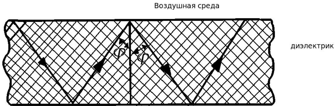
Рис. 4.4. Распространение электромагнитной волны в слое диэлектрика
