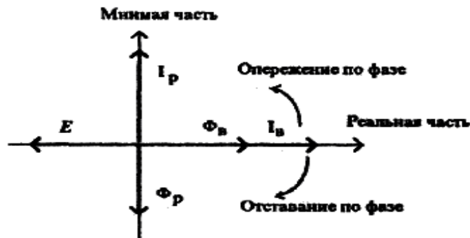
Рис. 8.12. Токи I_p и I_v в рефлекторе
