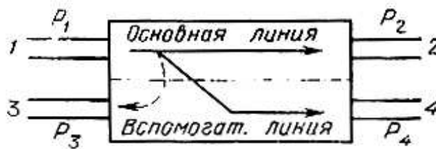
Рис. 5.12. Схема направленного ответвителя
