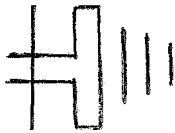
Рис. 6.2. Изображение директорных антенн на электрических схемах
