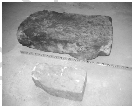
Рисунок 11 – Найденный керамический камень (вверху), современный керамический кирпич (внизу)
