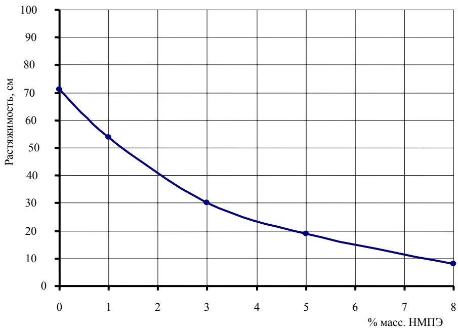
Рис. 5. Зависимость растяжимости битума БН 90/130 от количества НМПЭ
